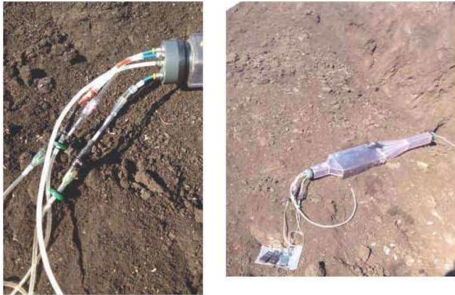
Figura 2.2: Assemblaggio strumentale per il campionamento mediante Wind Tunnel
