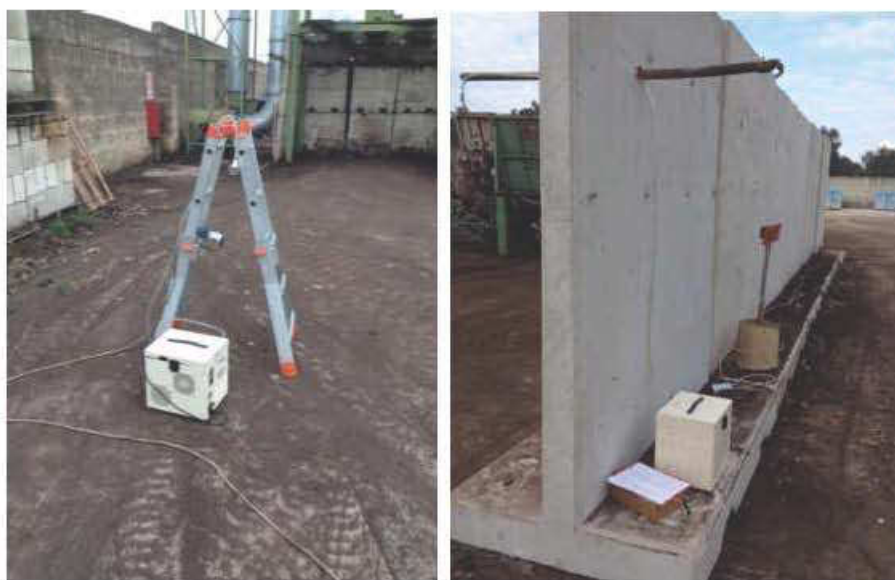
Figura 2.3: installazione strumentale per il campionamento delle PTS sottovento ai sistemi di vagliatura
